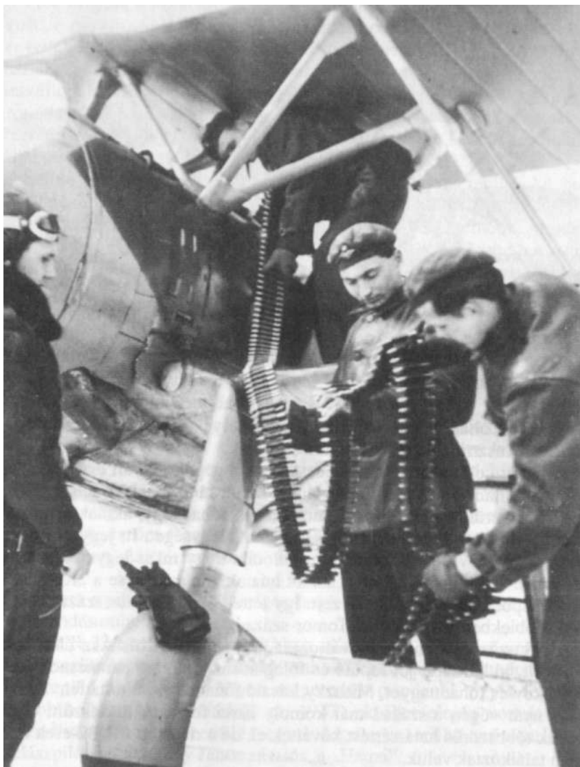
Etetik a Fiat-CR-42-es vadászgép 12,7 mm-es nehézgéppuskáit
